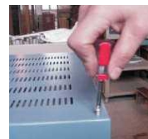
(1) 拧下上盖板四只螺丝，打开炉体上盖板，（有的炉体上盖板是 \phi 6 的内六角螺丝）
